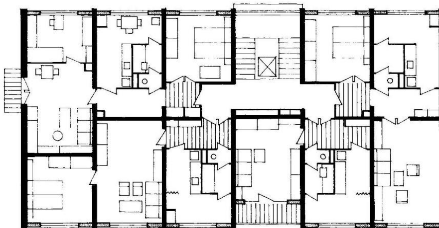
Obr. 1 – Ukázka půdorysu typického podlaží soustavy
