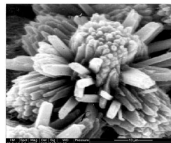
Obrázek č. 3 – GeoLite krystalizuje do monolitu podobnému hornině
