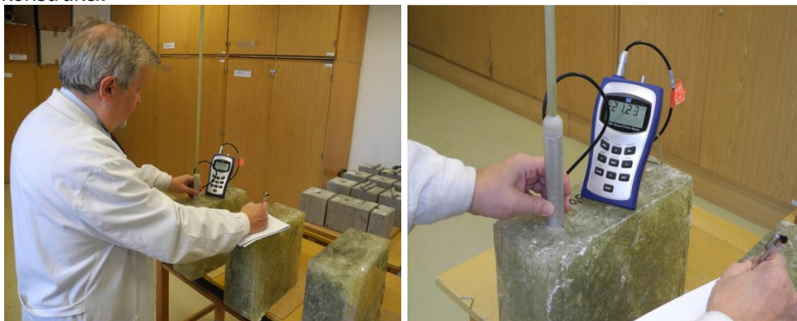
Obrázek 1: Kontrolní měření transparentních epoxidových vzorků s kovovými drátky v laboratoři na FAST VUT v Brně (nalevo) s detailním pohledem na používanou magnetickou sondu PeMaSo-2 (napravo).
