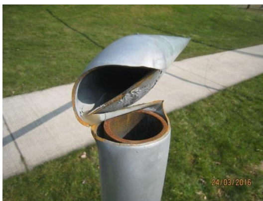
Obrázek 3.: Detail zlomení s pohledem na vnější a vnitřní trubku
