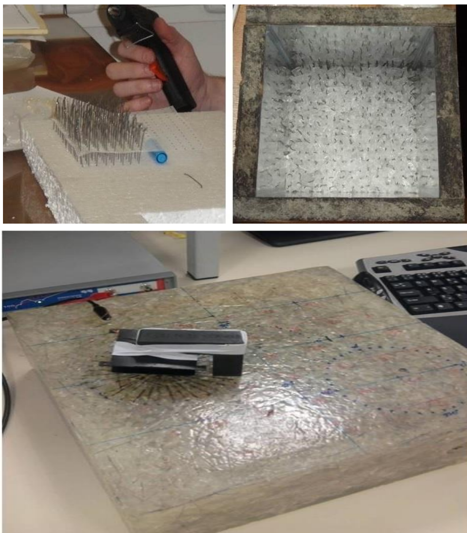
Obrázek 3: Ukázka přípravy transparentních epoxidových vzorků s garantovaným objemovým podílem a směrovým rozložením drátků (nahore nalevo) a hotový vzorek (nahore napravo) s následným využitím experimentálního zařízení pracujícím s harmonickým elektromagnetickým polem, vyvíjeného ve spolupráci s Ústavem mikroelektroniky FEKT VUT v Brně (dole).
