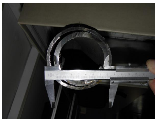
Obrázek 4.: Detail vnější a vnitřní trubky ( \phi 89.4, \phi 76.7)
